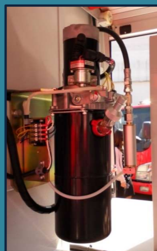
○油圧ポンプユニット
