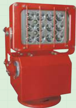
■ リモコン式60W LED投光器 LRC-62W(DC24V) 最大中心光度 140,000cd
