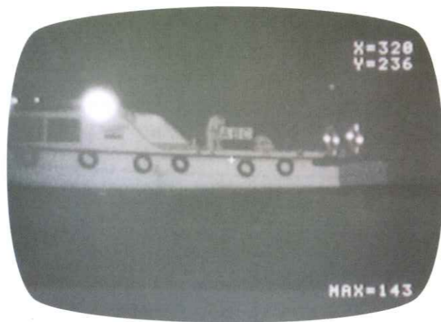
小型艇（16m 艇）による文字判別テスト（文字寸法 25cm 口）キセノン探照灯 2000W、距離 2000m
