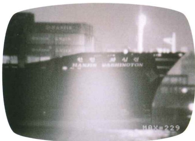
大型貨物船 船名判別例、キセノン探照灯 2000W、距離 2000m
