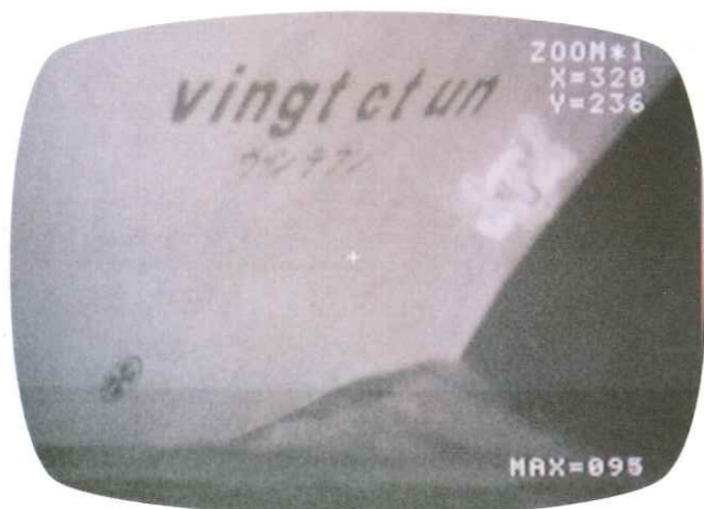
大型貨物船 船名判別例、キセノン探照灯 2000W、距離 2000m
