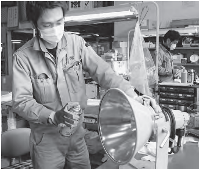
甲板照明用投光器の組立
